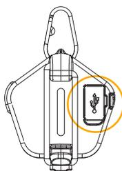
Carga el Beacon a través del puerto micro USB en la parte posterior. Se incluye un cable de carga micro USB de 15 cm.
